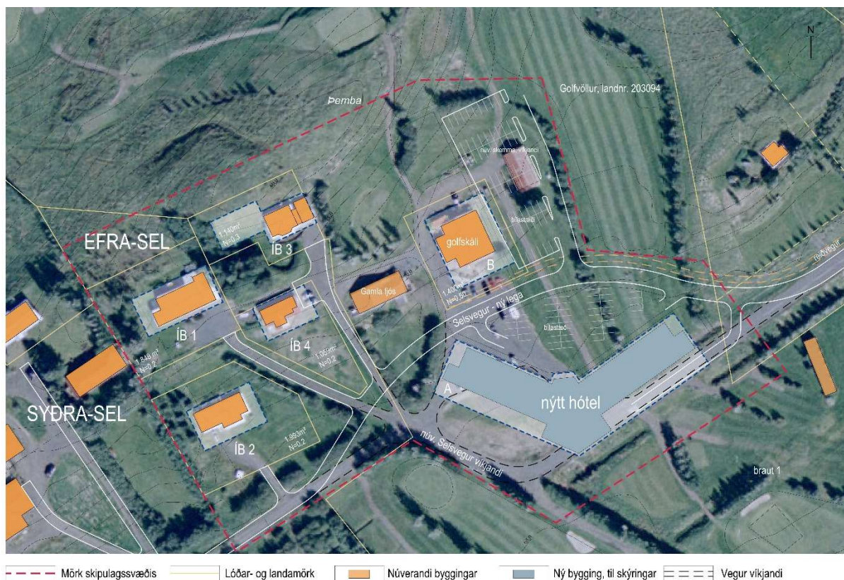
mynd 4. Skýringamynd - drög að breyttu deiliskipulagi við Efra-Sel þar sem hótélbygging er flutt suður fyrir golfskála. Vegfærsla skv. nýjstu hugmyndum sem þegar hefur verið kynnt lóðarhöfum á svæðinu.
