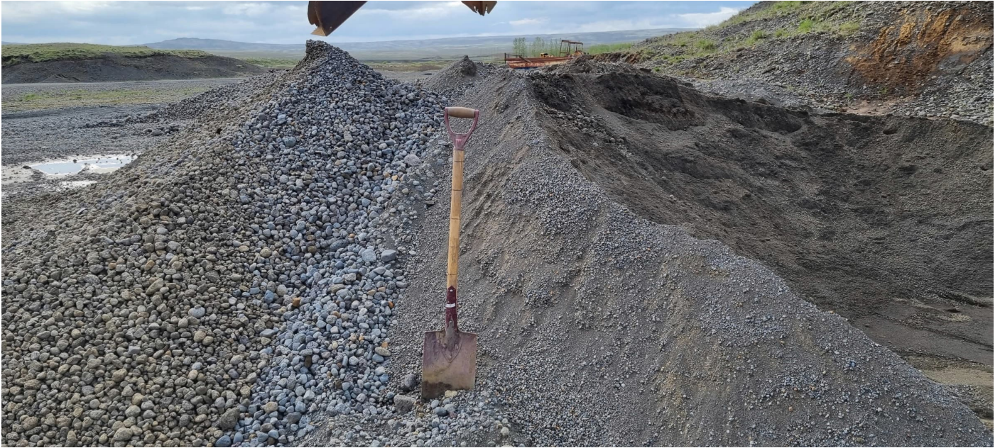
Mynd 87 Afurð flokkunarvélarinnar; einskorna mül í dren- eða síulag t.v. og sandur t.h. Um stærð skóflu og mælisþjalds, sjá mynd framar.
