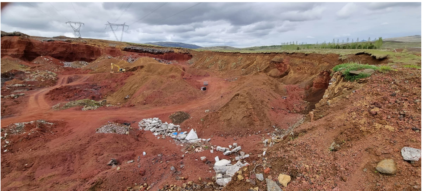
Mynd 103 Horft í NV yfir norðursvæði nyrðra hlutans, frá gömlum lokuðum aðkomuvegi. Efnisvinnsla gjalls og efnislosun steypubrota.
