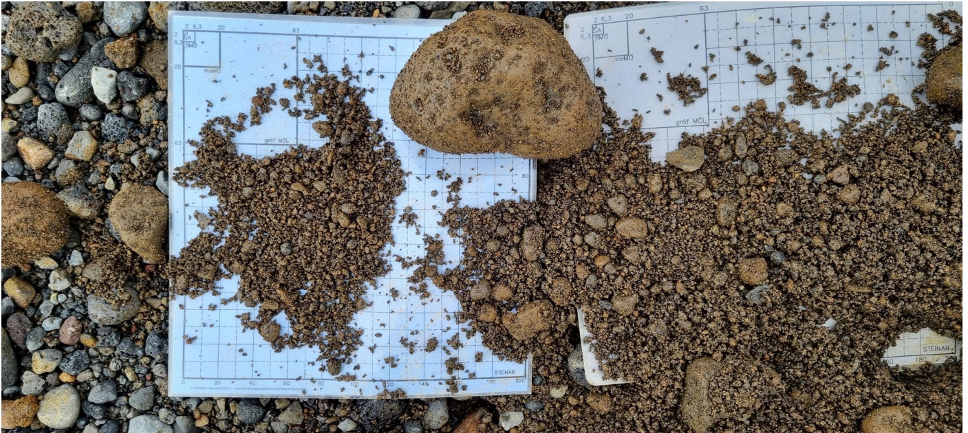
Mynd 43 Efnishaugar nyrst á efra palli, nærmynd. Ysti rammi matsblaðs er 200 mm á kant (mesta steinastærð), næsti er 63 mm (mesta malarstærð), þá 20 mm (mesta stærð meðalgerðrar malar), þá 6,3 (mesta stærð fingerðrar malar) og loks 2 mm mesta stærð sands). Sendin möl, steinar harpaðir úr. Líklega stærðaflokkur 0/63.
