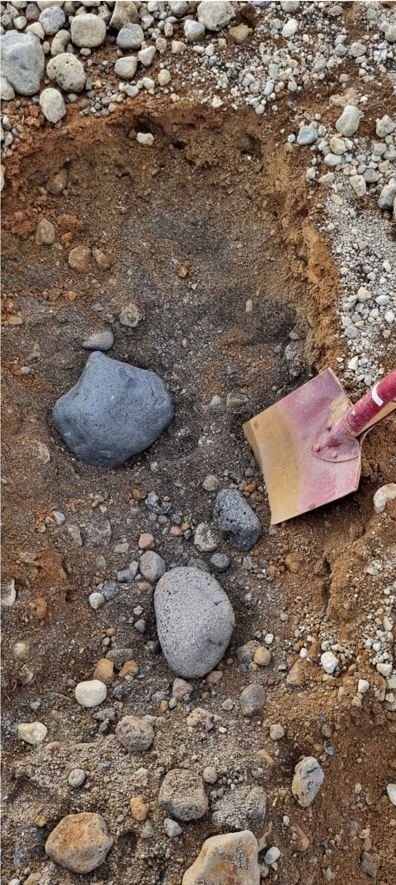
Mynd 19 E4 - Krókur neðri. Nærmynd af sjónmatsstað frá fyrri mynd, í grófgerðari efri hlutanum. Skóflublað er tæplega 300 mm á hæð. Jarðefnið er úr steinum (möskvastærð er 63 til 200 mm), möl (2 til 63 mm) og sandi (0,06 til 2 mm) og vottur af brúnu móberg í syltar- og sandstærðum.
