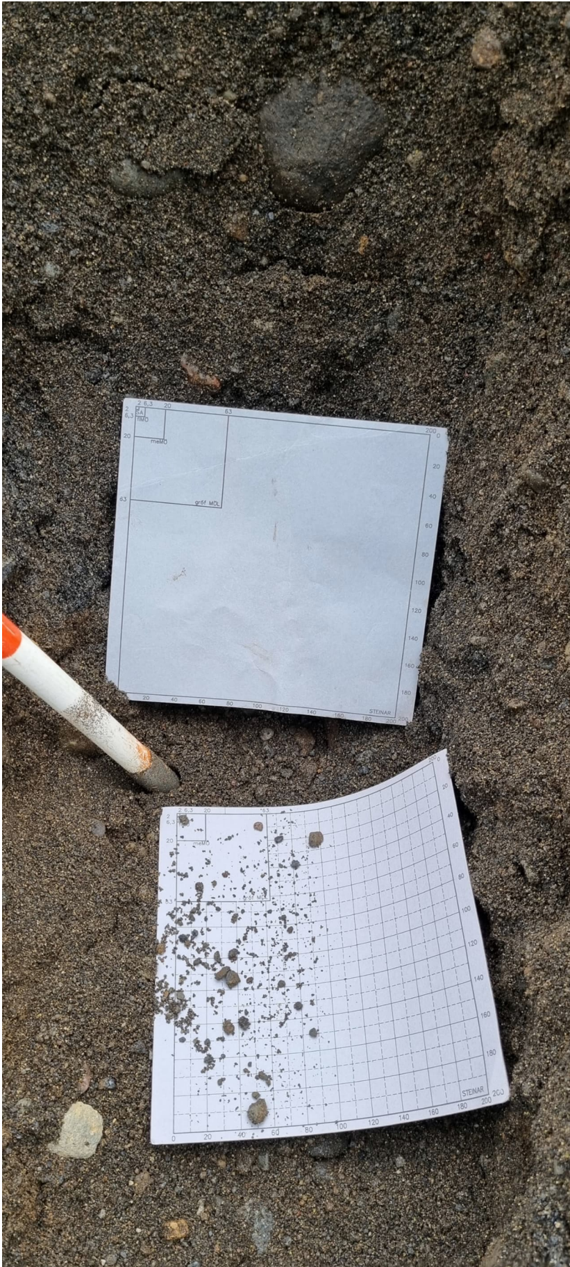
Mynd 15 E3 - Krókur efri. Nærmynd af sjónmatsstað frá fyrri mynd. Mælistöng með 20 cm hvítri afmörkun. Ysti rammi matsblaða er 200 mm á kant (mesta steinastærð), næsti er 63 mm (mesta malarstærð), þá 20 mm (mesta stærð meðalgerðrar malar), þá 6,3 (mesta stærð fingerðrar malar) og loks 2 mm mesta stærð sands).
