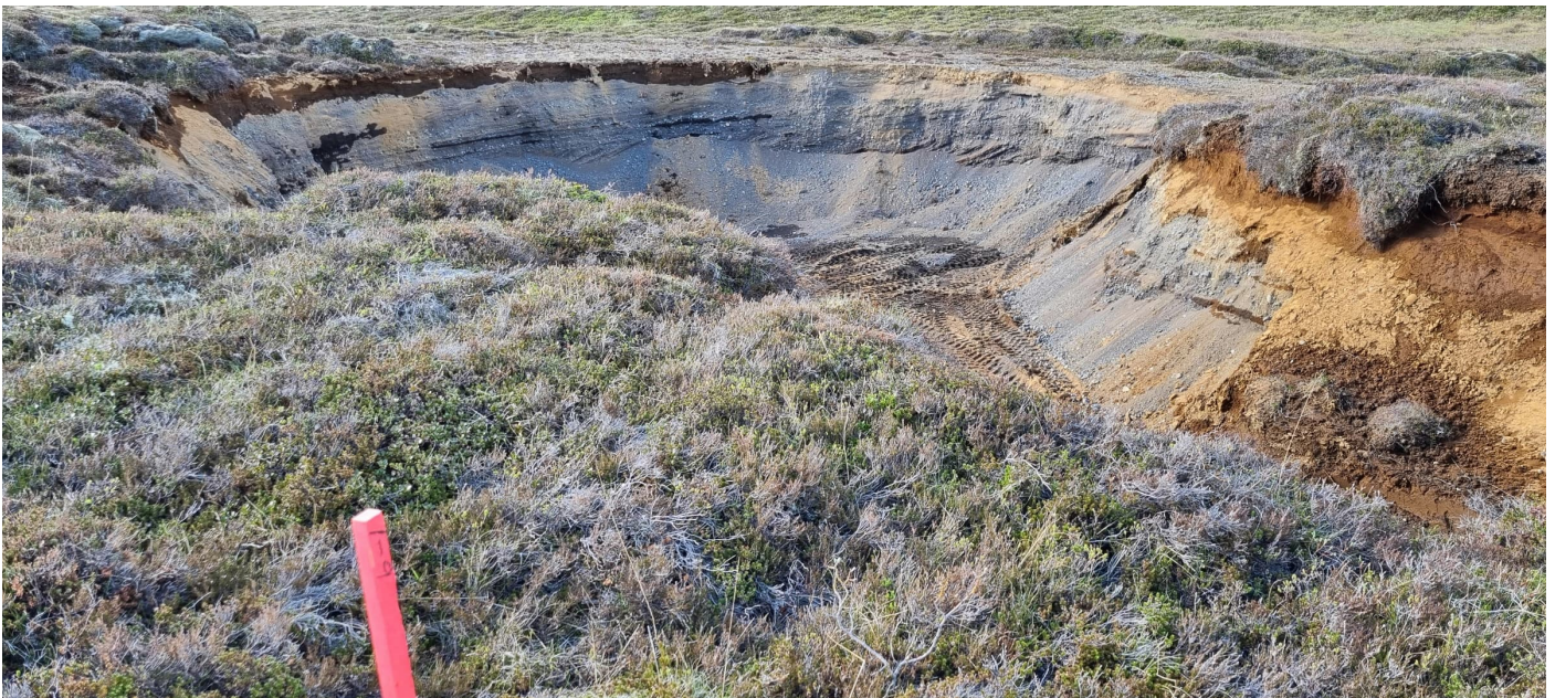
Mynd 31 E7 – Bíldsfell – vestur. Horft í N, frá vegslóð inn í efnistökuastál. Þurrlandisjarðvegur ofan á sjávartöðumalarhjalla með lítt hallandi topplögum og hallandi skálögum úr sendinni möl undir.
