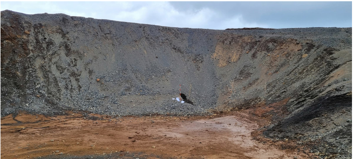
Mynd 14 E3 - Krókur efri. Horft í V á allt að 10 m hátt stál efnistökkunnar og botn þess. Skófla og 180 cm mælistöng, með 20 cm hvítri og rauðri afmörkun til skiptis, þar sem grafið var til sjónmats.
