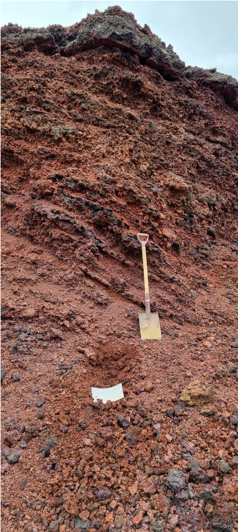
Mynd 71 Snið í gjallið syðst í vesturhluta efnistökusvæðis. Skófla um 1 m á lengd og mælispjald 22 cm á kant.
