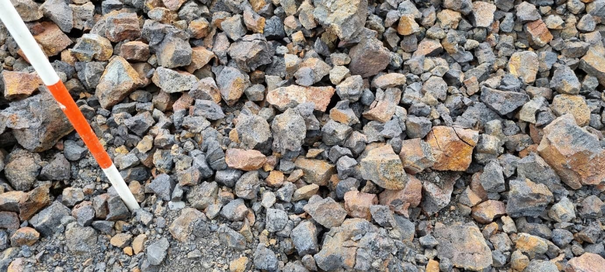
Mynd 7 E2 – Nesjavellir. Nærmynd af mulningi í haug sem framleiddur var af Ósk-Ási, verktaka ON, í febrúar 2022. Rautt bil á mælistöng er 20 cm langt.
