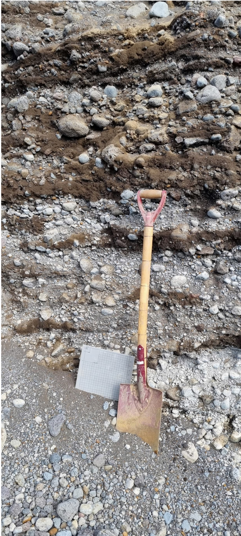
Mynd 82 Nærmynd af malarhjallanum. Strik á skóflu með 10 cm bili, en ysti rammi mælispjalds er 200 mm (hámarks steinastærð) og næsti 63 mm (hámarks malarstærð og hver rúða 10 mm).
