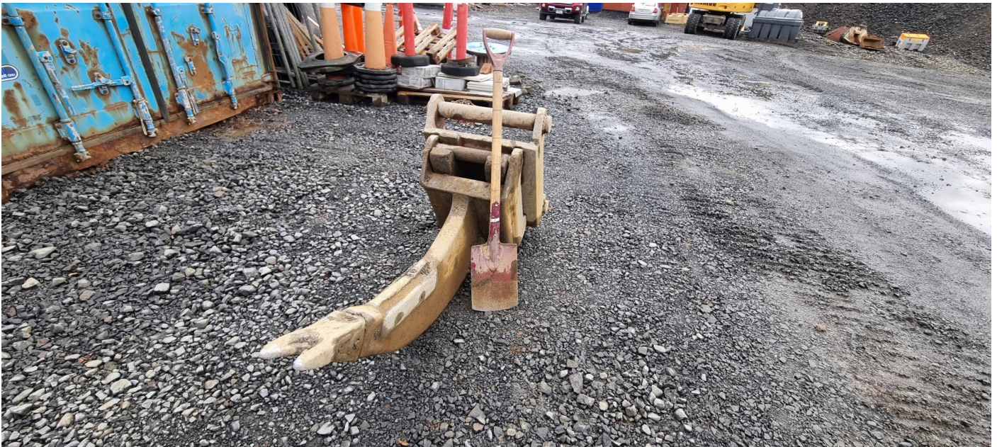
Mynd 55 E13 - Skriðugil, Syðri-Brú. „Klórán“ sem rekstraraðilinn kallar svo og hefur útbúið til að ráða hörðustu eitlana í fjallinu.
