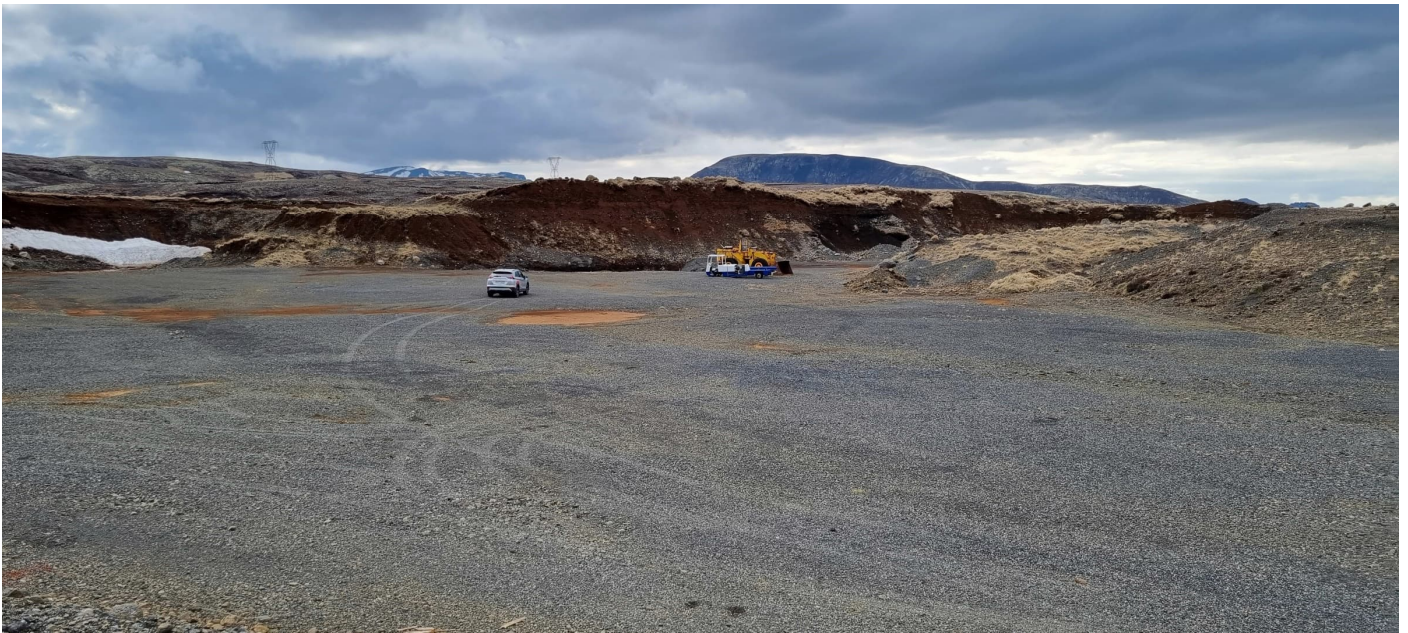
Mynd 16 E4 - Krókur neðri. Horft SV frá inngangi á svæðið. Botn svæðisins er þakinn mulningi af stærðaflokki 11/16 eða ámóta, sem hefur verið framleiddur á staðnum, líklega vegna til klæðingar vega. Leifar af efnisvinnslutækjum t.h. við miðju.
