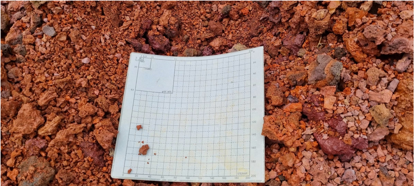
Mynd 72 Snið í gjallið syðst í vesturhluta efnistökusvæðis. Nærmynd frá fyrri mynd. Ysti rammi er 200 mm (stærsta steinastærð), næsti 63 mm (stærsta malarstærð).
